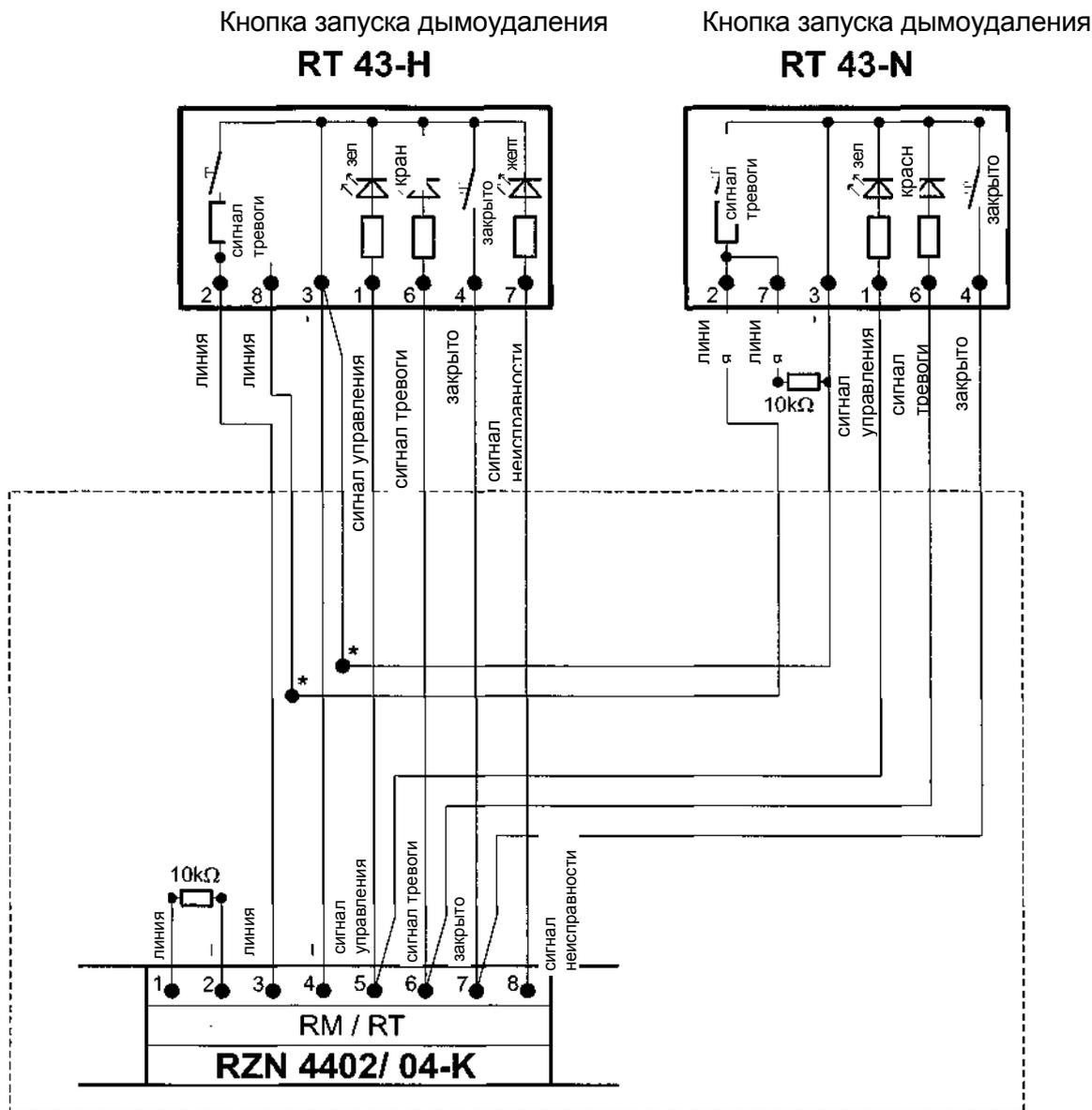
\* шунтирующее соединение устанавливается заказчиком
